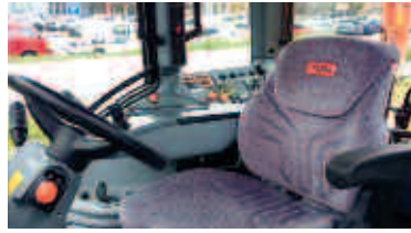
Le siège du conducteur peut être tourné à 180°C.
