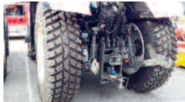
Avec les pneumatiques spéciaux, la largeur extérieure s'élève à 2.13 m.
